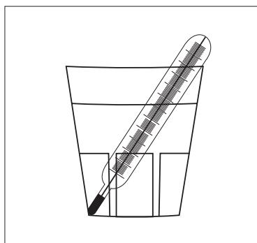
температуру продуктов, хранящихся в холодильнике, установите ручку терморегулятора в среднее положение, поставьте стакан с водой в центр камеры и опустите в него термометр с точностью градуировки  $+/- 1^{\circ}\text{C}$ . Если через 6 часов показание термометра соответствует показанию дисплея, холодильник работает normally. Измерения необходимо проводить в стационарном режиме работы (без
